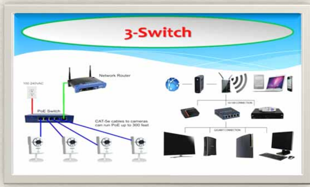
صورة توضح توصيل ال DVR ب Switch
