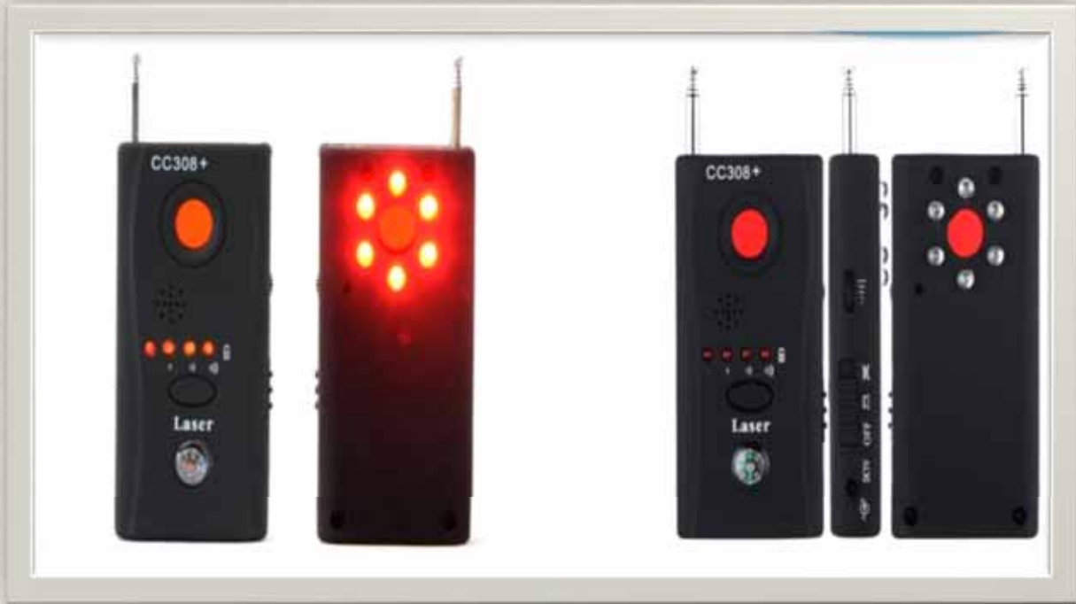
صورة للجهاز CC308 كاشف الكاميرات المخفية
